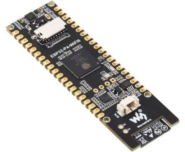
ESP32-P4-WIFI6 (Waveshare) — bicoeur RISC- V 400 MHz + ESP32-C6 (Wi-Fi 6), RAM externe : le terrain des LLM de quelques mégaoctets
